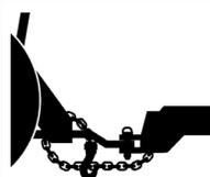
Ao acoplar o equipamento ao trator, utilize uma corrente para travar o cabeçalho do equipamento à barra de engate do trator.
